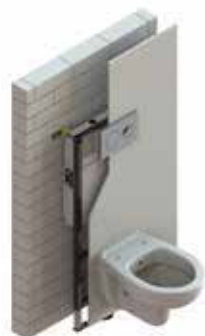
Επίτοιχο με επένδυση γυψοσανίδας
